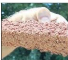
Der Boden besteht aus wasser-durchlässigem Granulat. Die Deckschicht bilden feine Gummikörner. • Foto: Speckmann
